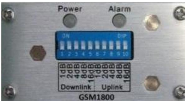
Добавляйте усиление ретранслятора одновременно в обоих направлениях Downlink (от базовой станции к абоненту) и Uplink (от абонента к базовой станции) уменьшением величины затухания соответствующих аттенуаторов до момента, когда зеленый цвет светодиодного индикатора ALARM сменится на оранжевый. Это означает, что ретранслятор вышел на свою номинальную мощность, при которой обеспечивается максимальный радиус зоны покрытия с соблюдением требований по линейности усиления.
